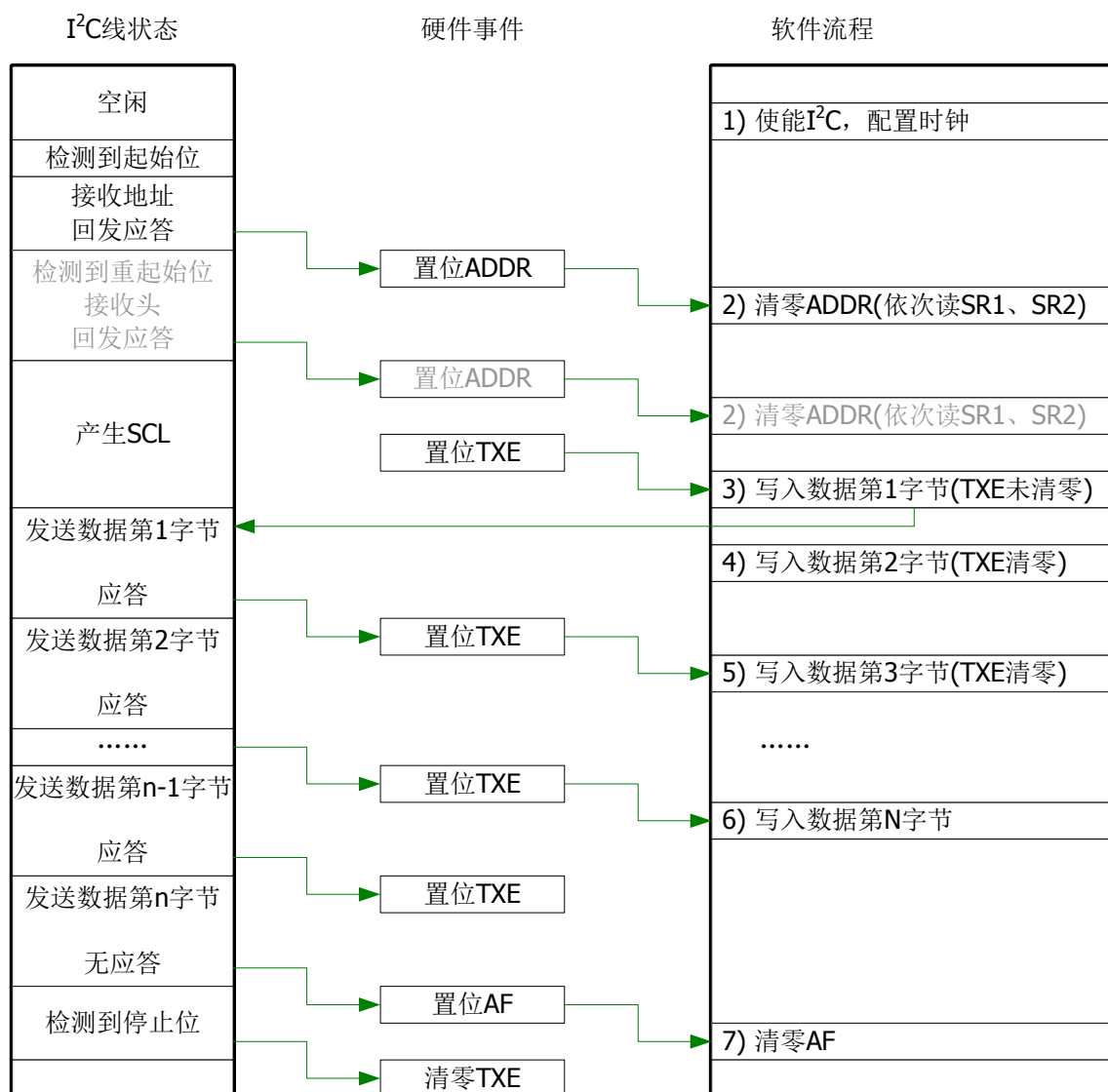
图 121 从机发送的程序流模型
