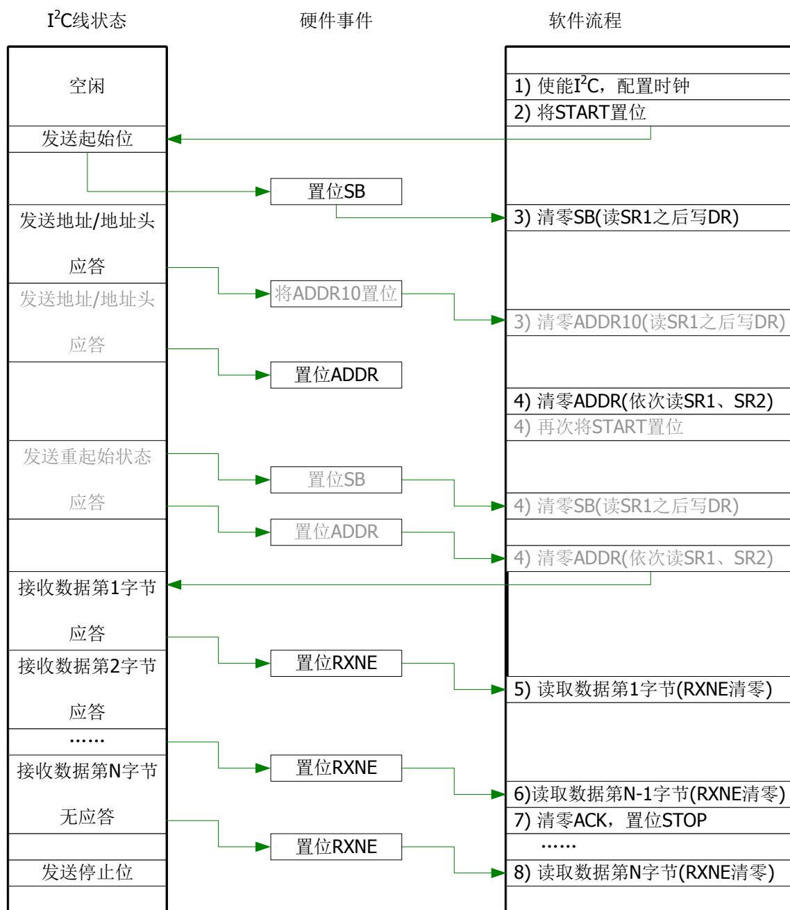
图 124 主机接收的程序流模型
