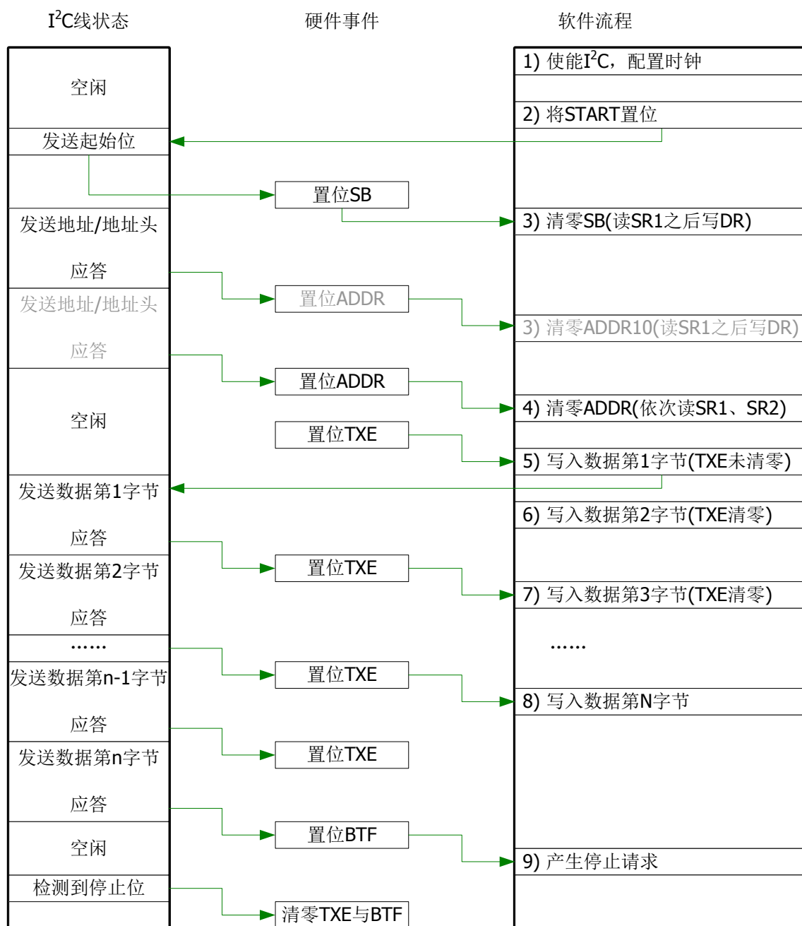
图 123 主机发送的程序流模型
