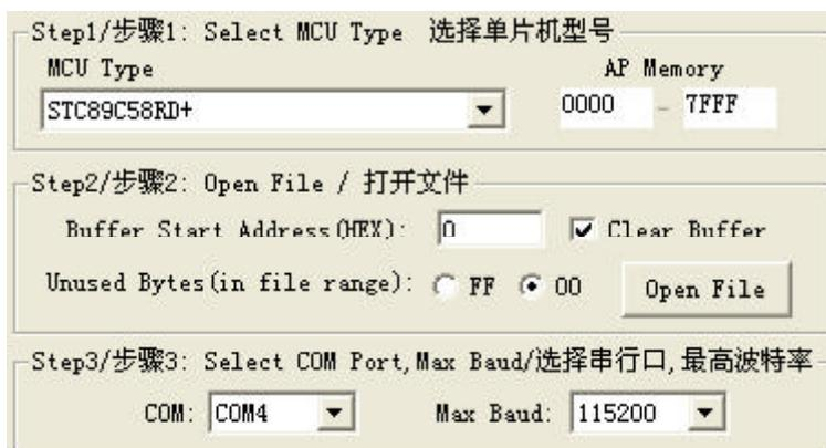
STC-ISP.exe 在“发送”完用户自定义下载命令后, 就会转去调用老的那一套下载命令, 而不管用户单片机程序收到命令没有。不过这个转换有些电脑有时需要将近 1S 的时间, 所以用户应用程序要延时 1S, 否则系统 ISP 程序收不到下载命令, 又会回到用户应用程序。
