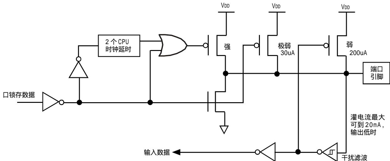
STC90LE51RC/RD+ 系列单片机为 3V 器件，如果用户在引脚加上 5V 电压，将会有电流从引脚流向 VDD，这样导致额外的功率消耗。因此，建议不要在准双向口模式中向 3V 单片机引脚施加 5V 电压，如使用的话，要加限流电阻，或用二极管做输入隔离，或用三极管做输出隔离。
