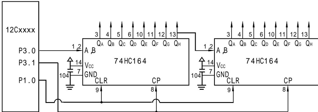
当单片机串行口工作在方式 0 的发送状态时，串行数据由 P3.0 (RxD) 送出，移位时钟由 P3.1 (TxD) 送出。在移位时钟的作用下，串行口发送缓冲器的数据一位一位地移入 74HC164 中。需要指出的是，由于 74HC164 无并行输出控制端，因而在串行输入过程中，其输出端的状态会不断变化，故在某些应用场合，在 74HC164 的输出端应加接输出三态门控制，以便保证串行输入结束后再输出数据。
