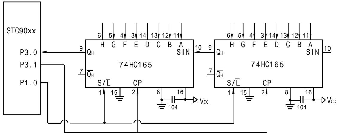
74HC165 是 8 位并行置入移位寄存器。当移位 / 置入端 ( $S/\bar{L}$ ) 由高到低跳变时，并行输入端的数据置入寄存器；当  $S/\bar{L}=1$ ，且时钟禁止端 (第 15 脚) 为低电平时，允许时钟输入，这时在时钟脉冲的作用下，数据将由  $Q_A$  到  $Q_H$  方向移位。
